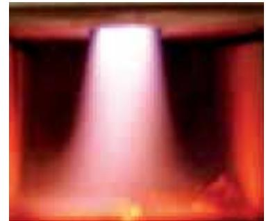
Vollständige Verbrennung der Holzgase in der unteren Brennkammer
