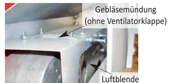
*HVS LC: ohne Ventilatorklappe, mit Luftblende*
